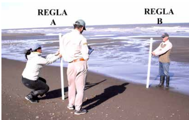
Figura 22. Ejemplo de medición de perfiles de playa con el método adaptado de Emery.
