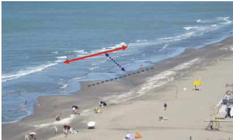
Figura 37. Sector donde debe ubicarse el elemento flotador (flecha roja) y la marca que debe realizarse en la playa (línea punteada verde) para efectuar las mediciones de la corriente litoral (velocidad). También se indica la distancia (flecha punteada azul) desde la zona superior de lavado ascendente hasta la corriente litoral. Foto: MAHC.
